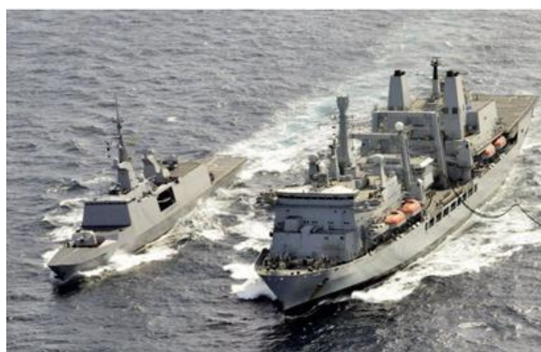
Illustration 93 : La frégate Guépratte, à gauche, pendant un ravitaillement à la mer en combustible, par le pétrolier ravitailleur RFA Fort Victoria, (Source : Marine nationale)
