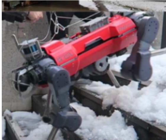
FIGURE 1.1 – Le quadrupède ANYMal dans un escalier enneigé. Image tirée des travaux de MIKI et al. 2022. Les auteurs proposent une approche qui permet à ce robot de suivre des humains sur des sentiers de randonnée.
