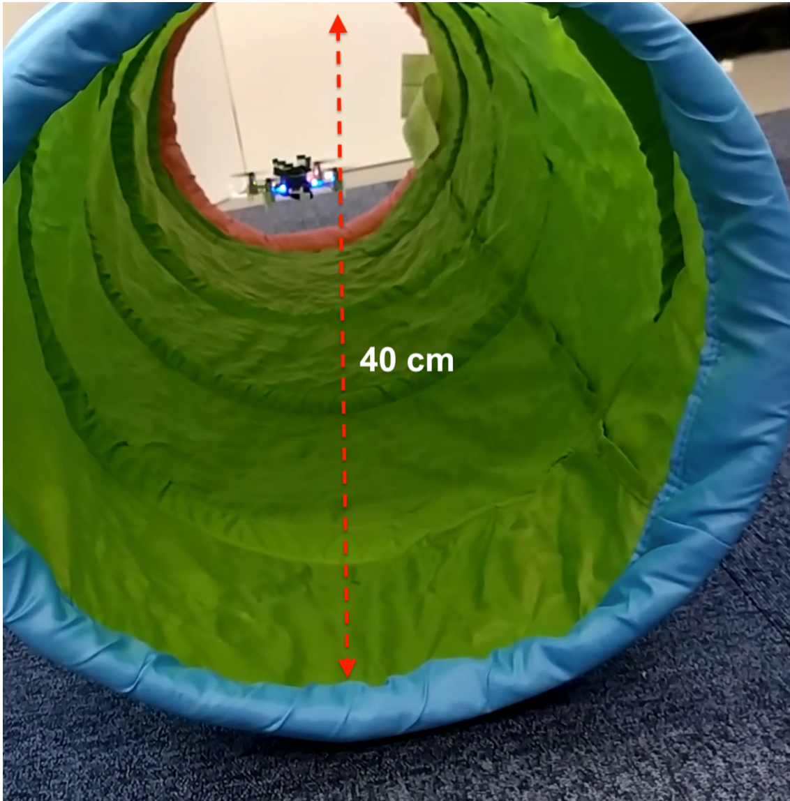
FIGURE 3.1 – Le Crazyflie dans un tuyau de 20cm de rayon.
