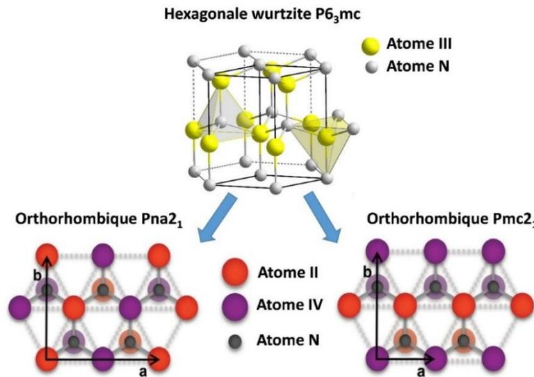
Figure I.3 : Structures orthorhombiques (groupe d'espace  $Pna2_1$  et  $Pmc2_1$ ) dérivées de la structure wurtzite des nitrures III-N avec un sous-réseau cationique ordonné. Les structures des composés II-IV- $N_2$  sont arrangées selon le plan  $c$  hexagonal (image modifiée à partir des travaux de Lahourcade et al.<sup>19</sup>).
