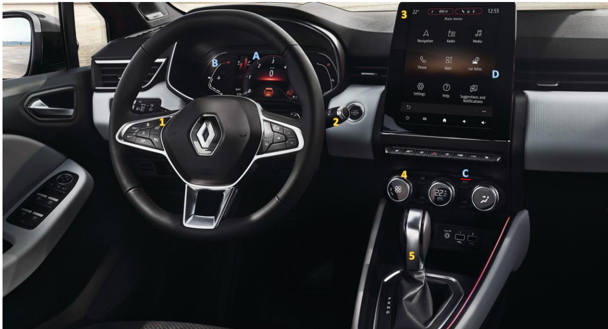
Figure 10. Exemples d’interfaces de commande et d’affichage embarquées dans le cockpit de la Renault Clio 5. Commandes : 1) bouton classique, 2) levier d’essuie-glace, 3) écran tactile, 4) rotary et 5) pommeau de vitesse. Affichages : A) compte-tours digital, B) jauge de température analogique, C) LED classique et D) écran tactile.
