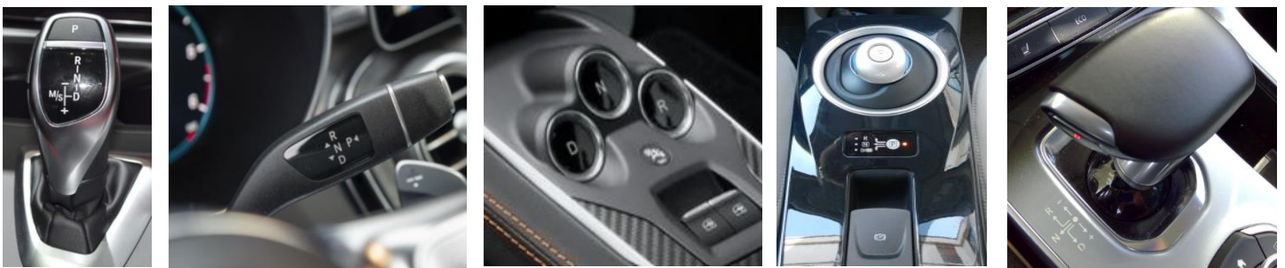
Figure 9. Différentes implémentations techniques de l'IHM de boîtes de vitesses. De gauche à droite : BMW, Mercedes, Alpine, Nissan, Renault.
