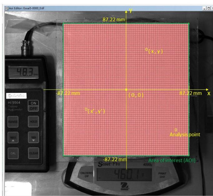
Figure II.13 : Image de référence, zone AOI et le système de coordonnées de Lagrange dans le logiciel *VIC-2D*.
