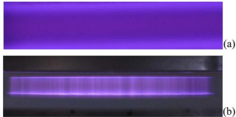
Figure 1.23 : Image d'une décharge DBD. a. en régime homogène, b. en régime filamentaire [149].
