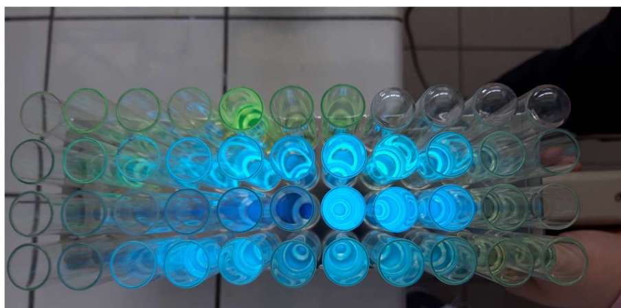
Figure 30 : Observation de la fluorescence du composé 3d (excitation à 365 nm).
