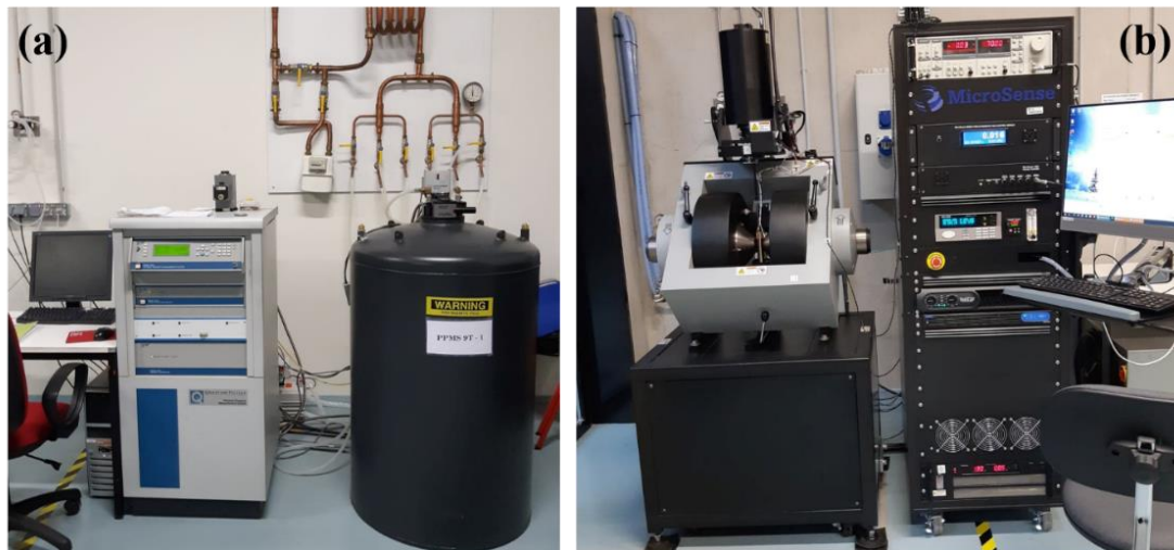
Figure I.6 : Appareils de mesures magnétiques (a) PPMS-9T et (b) VSM-ADE.
