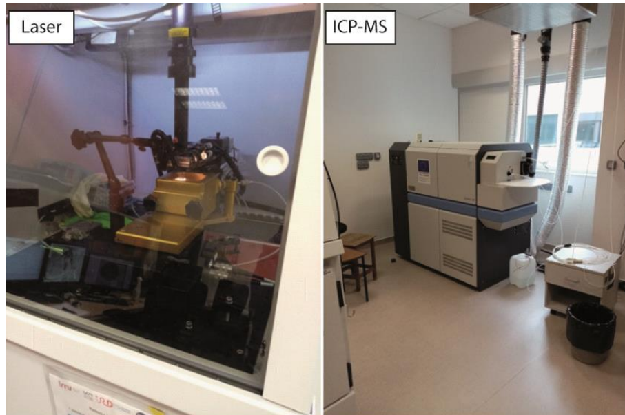
Figure 2.12 Spectrométrie de masse à plasma induit par couplage inductif par ablation au laser (LA-ICP-MS) du Laboratoire Magmas et Volcans de Clermont-Ferrand.
