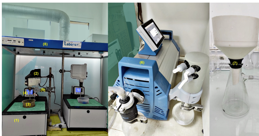
FIGURE 6.1 – Montage expérimental. (1) : Bain thermostaté. (2) : Agitateur. (3) : Réacteur batch. (4) : Thermostat. (5) : Ampoule d'acide sulfurique. (6) : Pompe à vide. (7) : Dispositif de filtration. (8) : Hotte de laboratoire.
