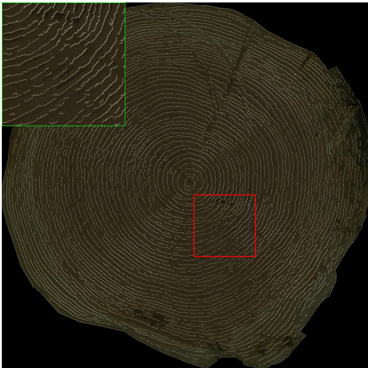
FIGURE 3.27 – Résultat final de la segmentation des limites de cernes. En haut à gauche de chaque image, un zoom du rectangle rouge.
