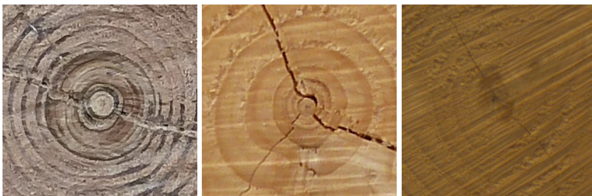
FIGURE 4.8 – Craquelures présentes proches de la moelle. Ces craquelures apparaissent lors du séchage du bois.
