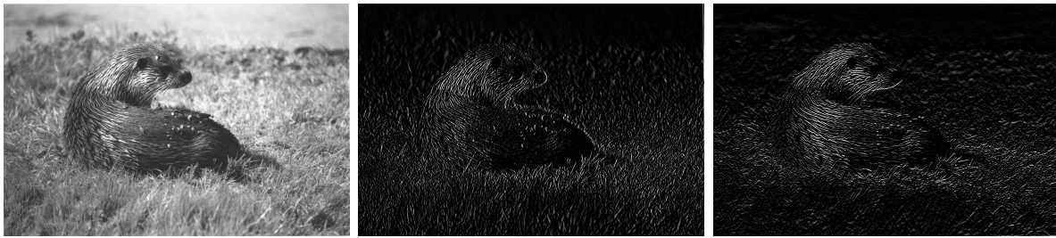
FIGURE 1.8 – Image en niveaux de gris. Dérivées en X et Y à l’aide des masques de Sobel.
