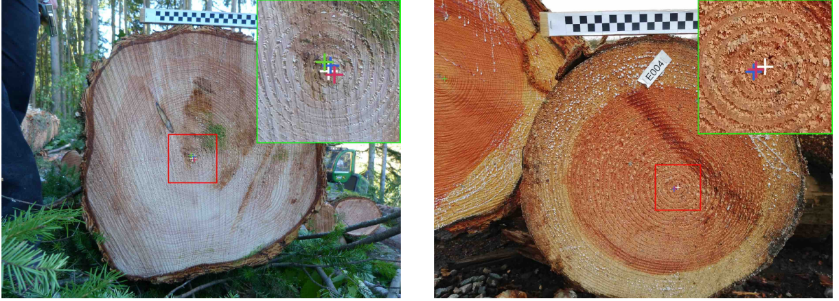
FIGURE 4.16 – Deux exemples où notre méthode n’arrive pas à moins de 5 mm de la vérité terrain. La vérité terrain est la croix blanche, la croix verte est le résultat du réseau YOLO v3 [Kurdthongmee, 2020], celle en bleue montre la moelle détectée par [Schraml and Uhl, 2013], et notre méthode est représentée par la croix rouge.
