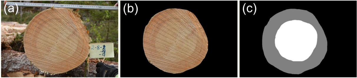
FIGURE 2.8 – Exemple d’une image utilisée dans l’article [Raatevaara et al., 2020]. En (a) l’image d’origine, en (b) la segmentation manuelle de la grume, en (c) la vérité terrain (en blanc le duramen, en gris l’aubier).
