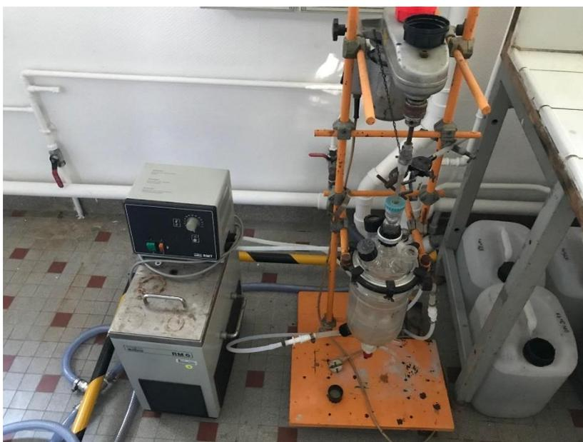
Figure 0-7 : Réacteur utilisé pour les essais de lixiviation.
