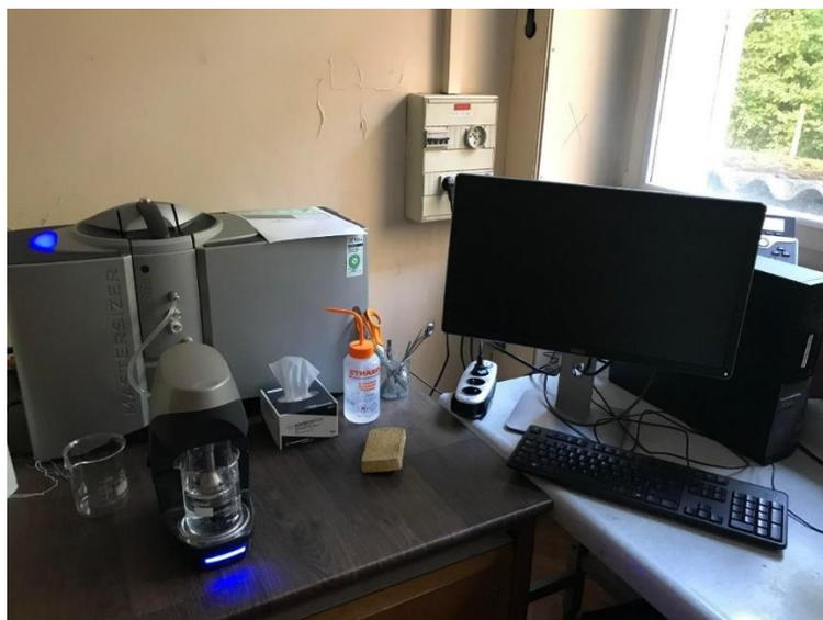
Figure 0-2 : Granulomètre Malvern Mastersizer 3000.
