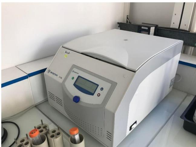
*Figure 0-12 : Centrifugeuse Sigma 316-L.*
