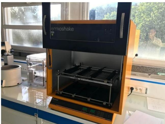
*Figure 0-11 : Agitateur thermostaté Thermoshake Gherardt.*
