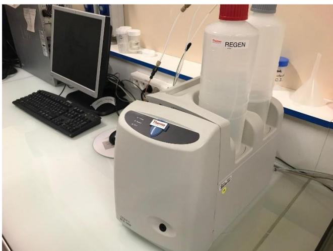
Figure 0-9 : Système de chromatographie ionique.
