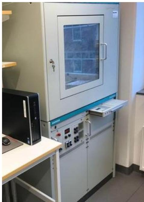
Figure 0-14 : Diffractomètre Siemens D5000.
