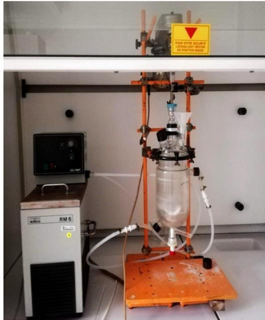
Figure II-1 : Réacteur utilisé pour les tests de lixiviation
