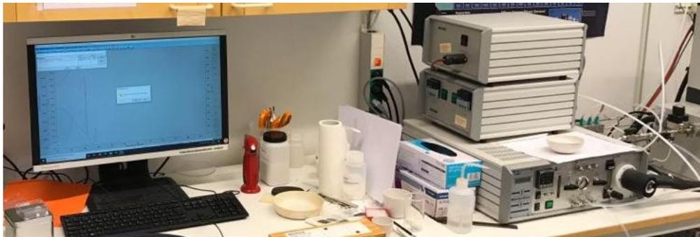
*Figure 0-15 : Analyseur thermogravimétrique Netzsch STA 449 F3 Jupiter.*
