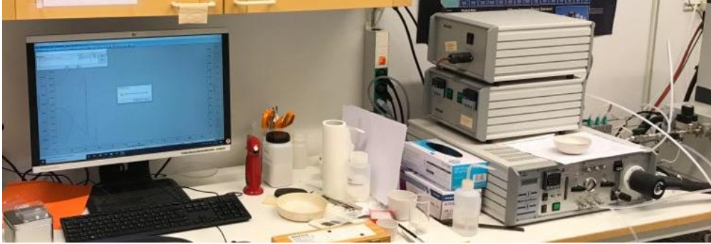
Figure 0-15 : Analyseur thermogravimétrique Netzsch STA 449 F3 Jupiter.
