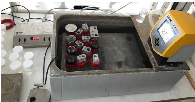
Figure IV-8 : Installation utilisée pour étudier la cinétique de précipitation en présence d'anti-solvant.
