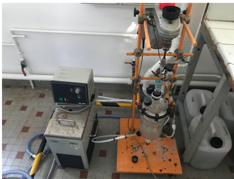
Figure 0-7 : Réacteur utilisé pour les essais de lixiviation.
