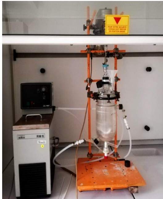
Figure II-1 : Réacteur utilisé pour les tests de lixiviation
