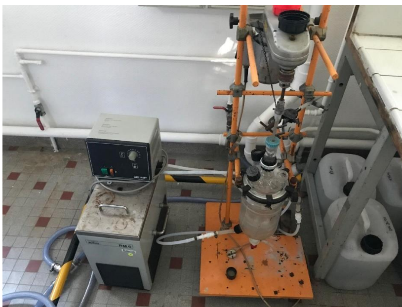
Figure 0-7 : Réacteur utilisé pour les essais de lixiviation.
