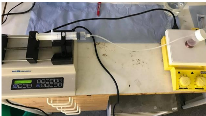
Figure IV-7 : Installation utilisée pour ajouter l'anti-solvant à la phase aqueuse à l'aide d'une pompe à seringue.
