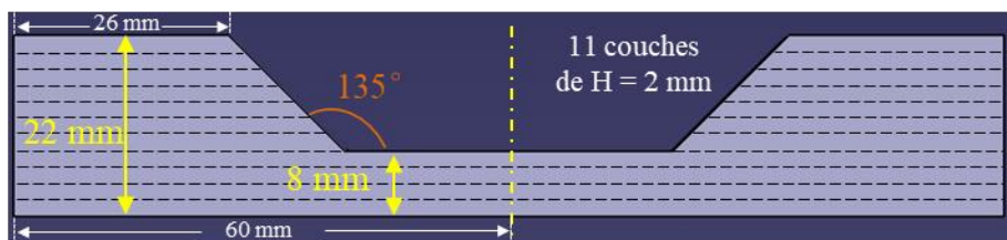
a) Planification de la fabrication du mur de hauteur variable
