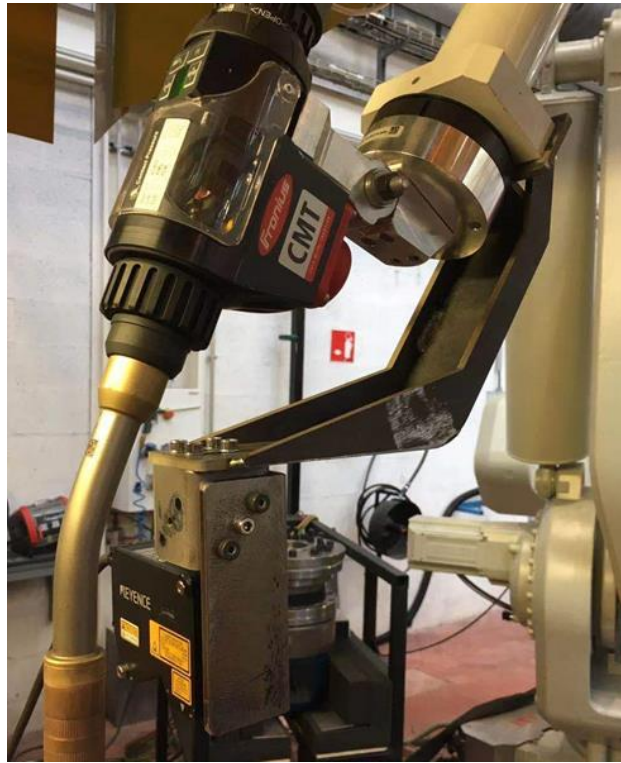
Figure 2.9 Système support du capteur réalisé
