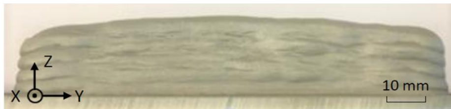
b) Mur déposé avec la trajectoire à direction alternée
