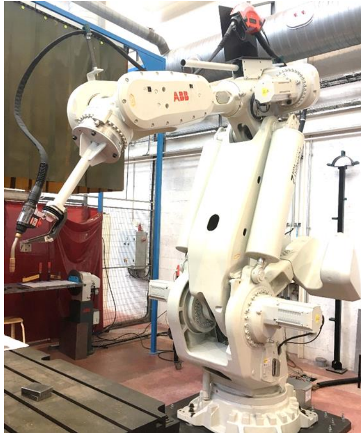
Figure 1.6 Robotisation du procédé FAAF dans nos travaux par le robot ABB IRB 8700
