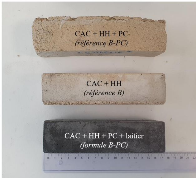
Figure 5 Photos des mortiers B et B-PC après 45 jours de conservation sous eau
