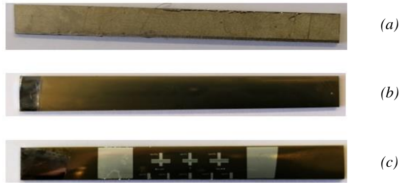
Figure 2. 35 : (a) Barreau d'alliage de titane rugueux, (b) couche de ZnO sur le barreau poli, (c) Résonateur réalisé sur la structure ZnO/alliage de titane.
