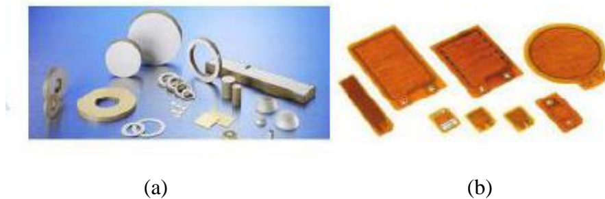
Figure 1. 4 : (a) céramiques PZT (Titrano-Zirconate de plomb), (b) films PVDF (Polyfluorure de Vinylidène en PolyVinylidène Fluoride).
