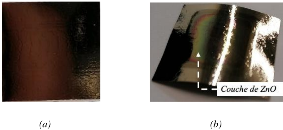
Figure 4.22 : (a) pièce de Metglas, (b) pièce de Metglas après dépôt de la couche de ZnO
