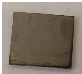
Figure 2. 10 : Échantillon de titane après découpe.
