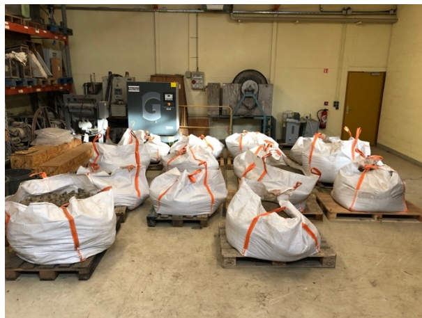
Figure 10. Stockage en big-bags des différentes classes granulométriques séparées après criblage du matériau terreux.
