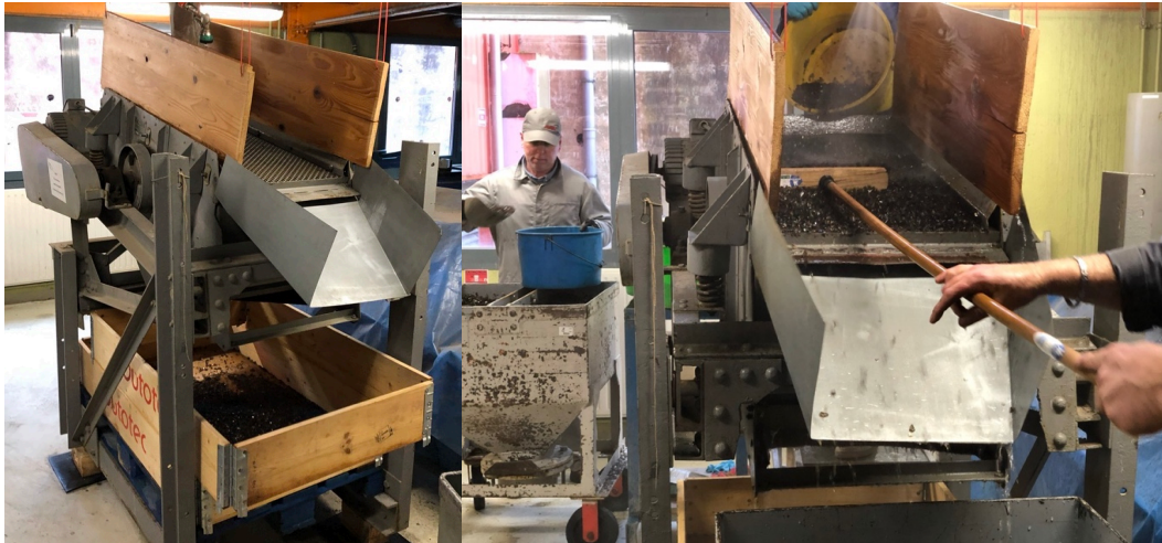
Figure 11. Cribleur vibrant utilisé pour le criblage du matériau inerte (verre).
