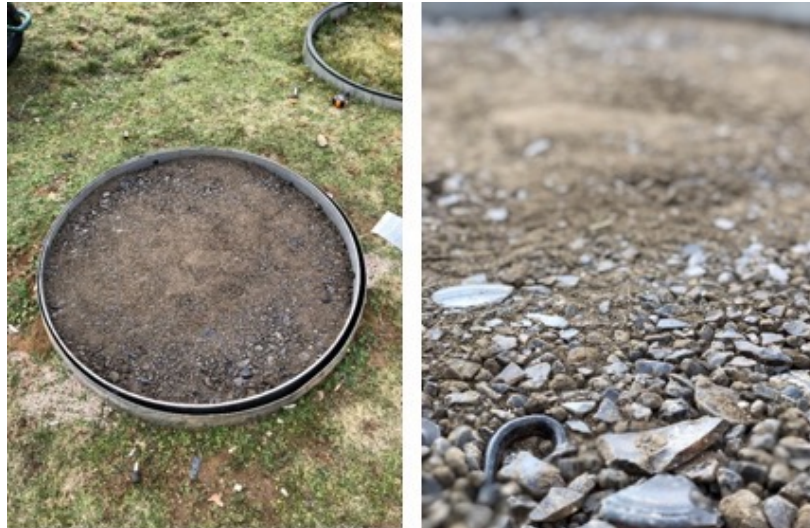
Figure 18. Lysimètre contenant la fraction grossière inerte et zoom sur la fraction grossière – FGI.
