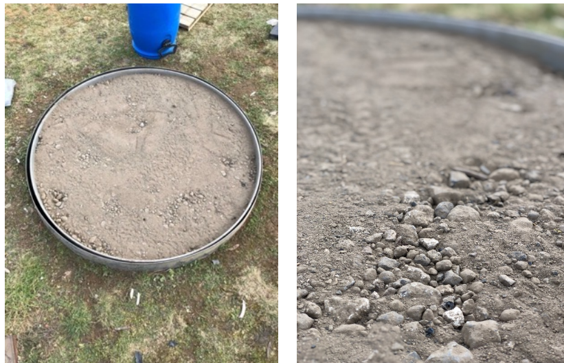
Figure 17. Lysimètre contenant la fraction grossière endogène et zoom sur la fraction grossière – FGE.
