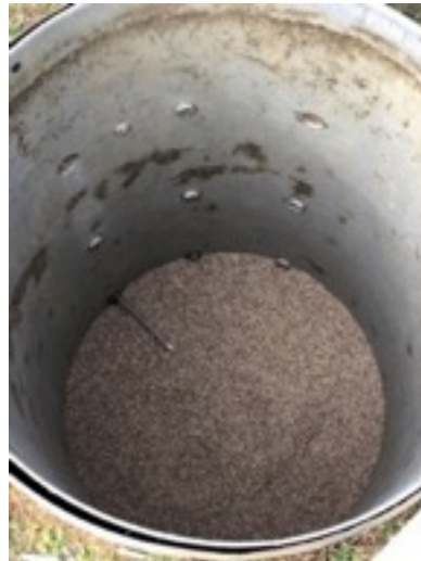
Figure 16. Remplissage des lysimètres : couche de sables et graviers de filtration.
