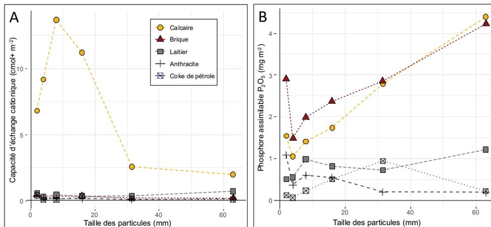
Figure 42. Évolution des paramètres mesurés en fonction de la taille des particules pour les cinq matériaux modèles. Concentration surfaciques : (A) Phosphore assimilable ( $P_2O_5$  méthode Olsen  $mg\ m^{-2}$ ) ; (B) Capacité d'échange cationique ( $cmol+ m^{-2}$ ).
