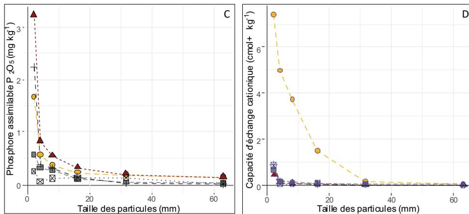
Figure 40. Évolution des paramètres mesurés en fonction de la taille des particules pour les cinq matériaux modèles. C : Phosphore assimilable (P<sub>2</sub>O<sub>5</sub> méthode Olsen mg kg<sup>-1</sup>) ; D : Capacité d'échange cationique (cmol+ kg<sup>-1</sup>).
