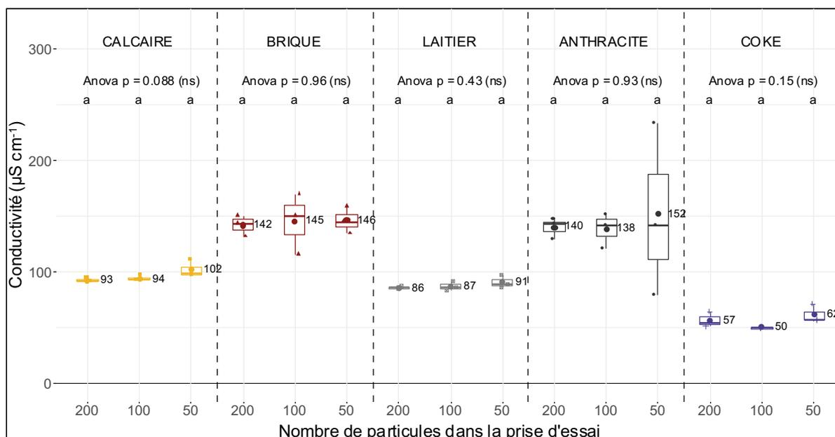
Figure 38. Vérification de l'influence du nombre de particules sur l'expression de la conductivité électrique spécifiques ( $\mu\text{S cm}^{-1}$ ) pour des particules de classe granulométriques 2-4 mm de calcaire, brique, laitier de haut fourneau, anthracite et coke de pétrole (moyenne  $\pm$  écart-type ;  $n = 3$ ). Pour chaque matériau, des lettres différentes indiquent une différence significative selon le test de Tukey HSD ( $p$ -value  $< 0,05$ )
