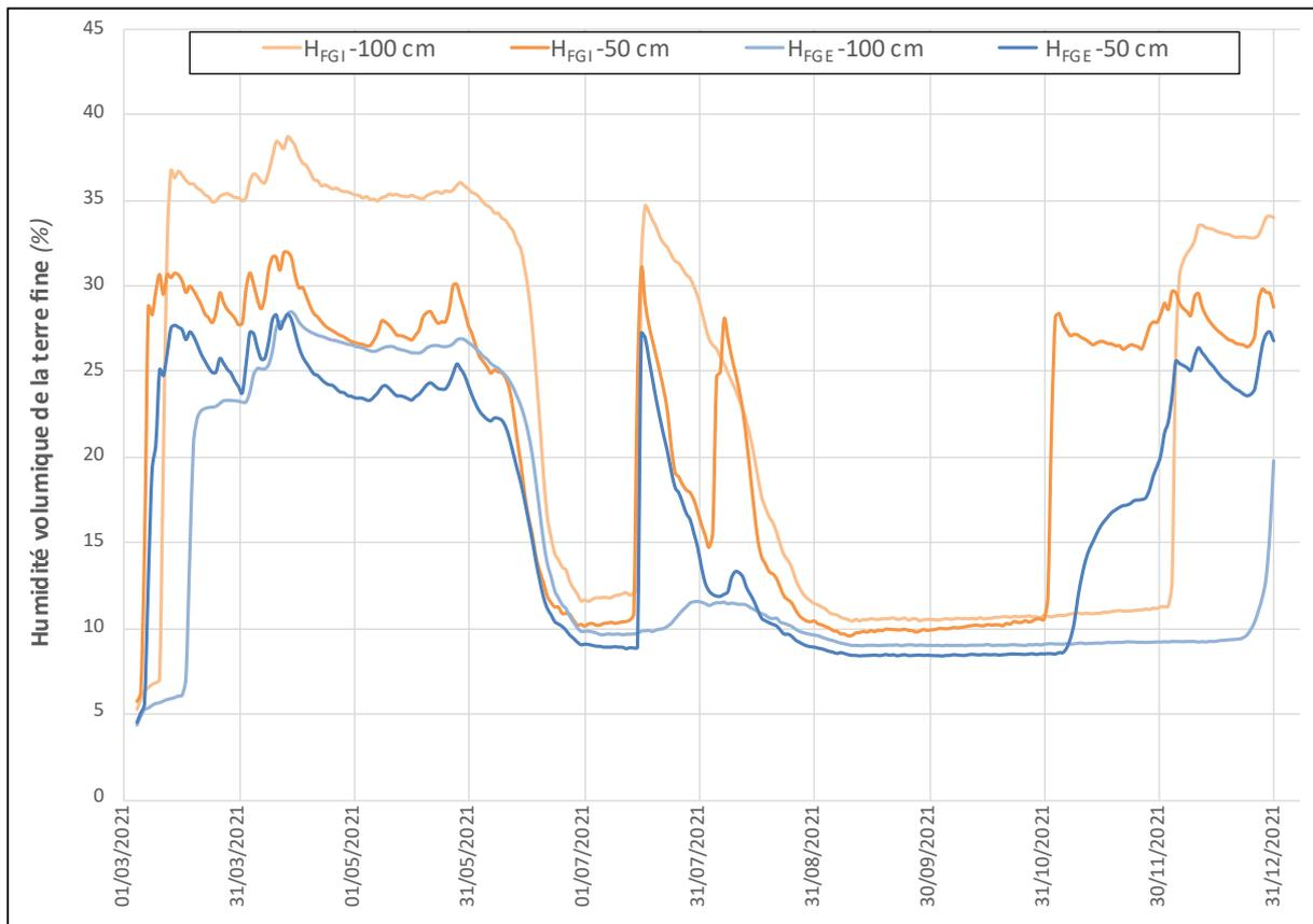
Figure 60. Évolution de l'humidité volumique de la terre fine (%) au cours du temps. Modalité fraction grossière endogène FGE : humidité volumique  $H_{FGE}$ -50cm (ligne bleu foncé) et humidité volumique  $H_{FGE}$ -100cm (ligne bleu clair); Modalité fraction grossière inerte FGI : humidité volumique  $H_{FGI}$ -50cm (ligne orange foncé) et humidité volumique  $H_{FGI}$ -100cm (ligne orange clair).
