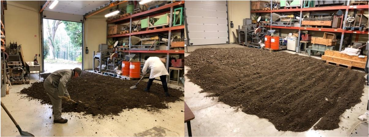
Figure 6. Séchage du matériau terreux.
