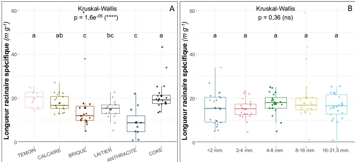
Figure 52. Évolution de la longueur racinaire spécifique ( $m g^{-1}$ ) des plantules en fonction des matériaux toutes classes granulométriques confondues (A) et en fonction de la taille des particules tous matériaux confondus (B) (moyenne  $\pm$  écart-type ;  $n = 4$ ). Pour chaque matériau, des lettres différentes indiquent une différence significative selon la procédure post-hoc de différence la moins significative de Fisher ( $p$ -value  $< 0,05$ ).
