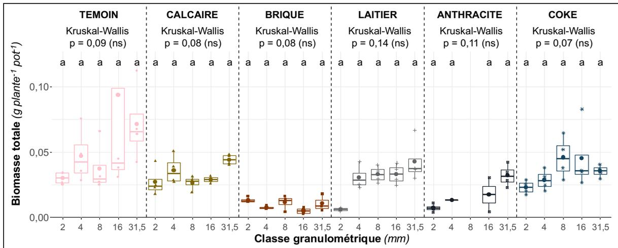
Figure 51. Évolution de la biomasse totale par plante et par pot ( $\text{g plante}^{-1} \text{pot}^{-1}$ ) en fonction de la taille des particules pour chaque matériau (moyenne  $\pm$  écart-type ;  $n = 4$ ). Pour chaque matériau, des lettres différentes indiquent une différence significative selon la procédure post-hoc de différence la moins significative de Fisher ( $p$ -value  $< 0,05$ ).
