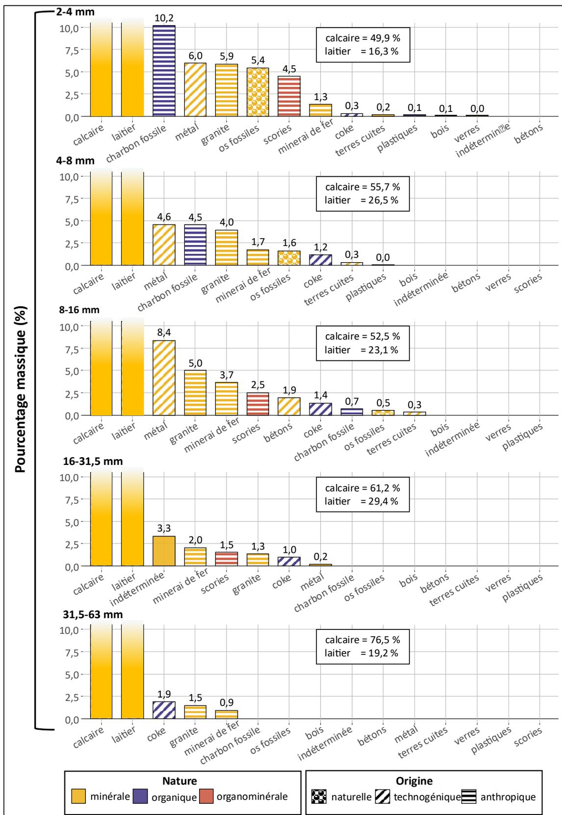
Figure 25. Proportion massique (%) des constituants de la fraction grossière du matériau terreux répartis au sein des classes granulométriques en fonction de leur nature et de leur origine. L'axe des ordonnées est coupé afin de faciliter la visualisation de la figure.
