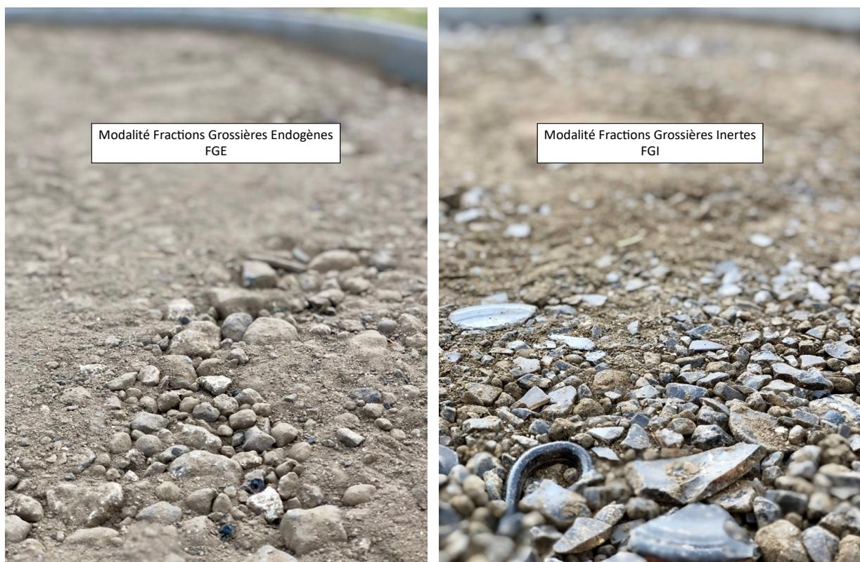
Figure 57. Aspect des modalités fractions grossières endogènes (FGE à gauche) et fractions grossières inertes (FGI à droite) lors de la mise en œuvre des dispositifs lysimétriques en mars 2021
