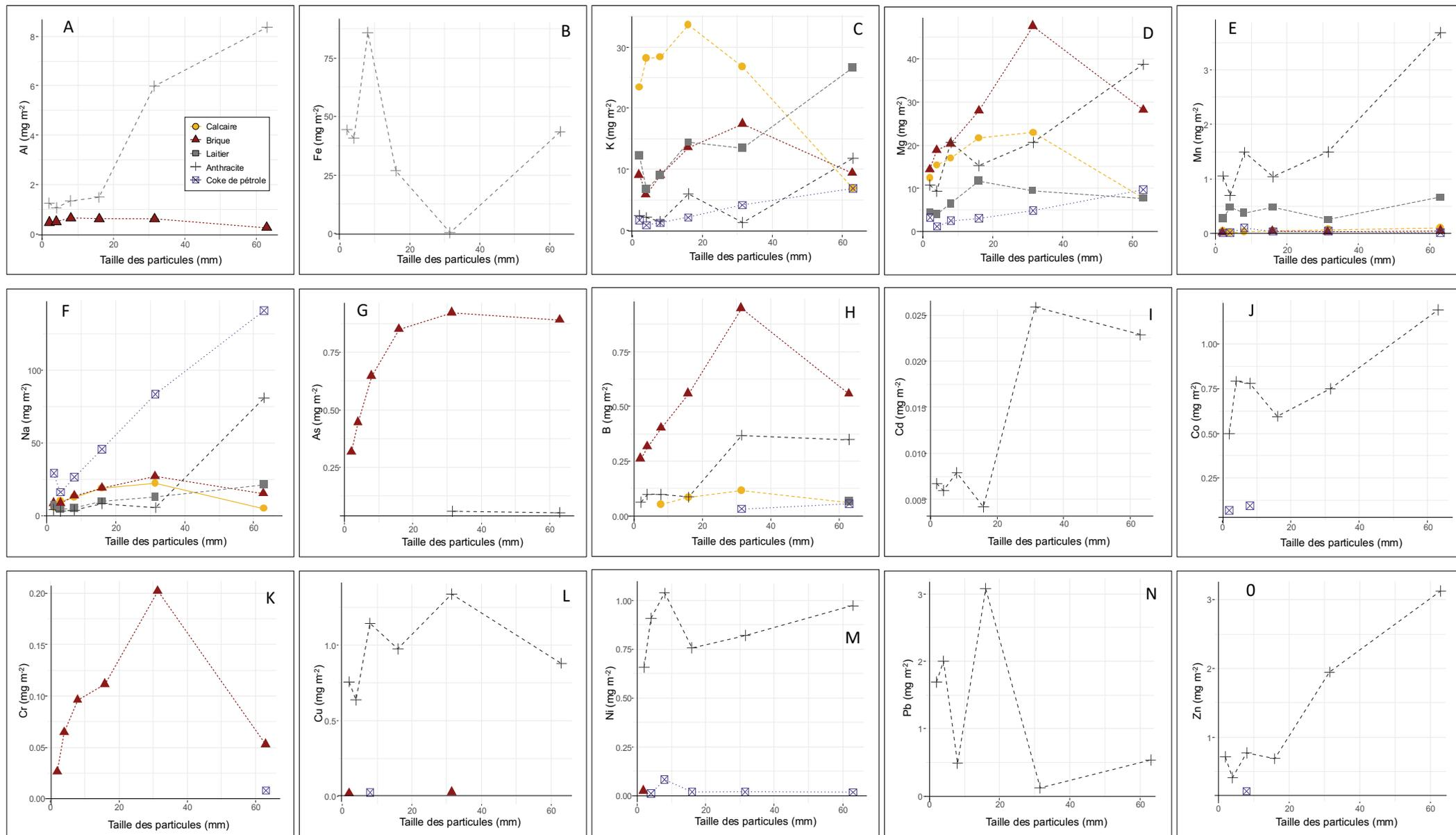
Figure 43. Concentrations surfaciques en éléments majeurs et en traces extraits au  $\text{CaCl}_2$  ( $\text{mg m}^{-2}$ ) en fonction de la taille des particules pour les 5 matériaux modèles. (A) aluminium, (B) fer, (C) potassium, (D) magnésium, (E) manganèse, (F) sodium, (G) arsenic, (H) baryum, (I) cadmium, (J) cobalt, (K) chrome, (L) cuivre, (M) nickel, (N) plomb et (O) zinc.
