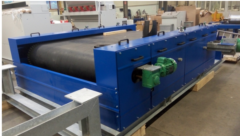
FIGURE 1.5 – Séparateur à courants de Foucault (Raoul Lenoir)
