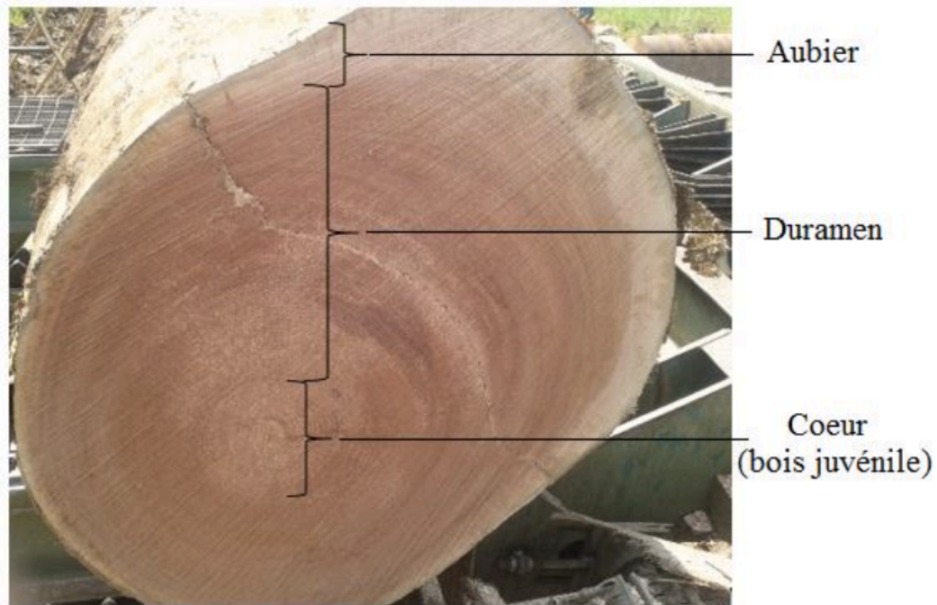
Figure 2. Section transversale du bois d'okoumé (Obame, 2020).
