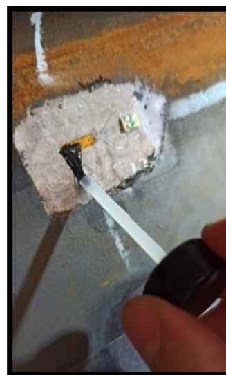
(d) Résine appliqué sur la jauge
