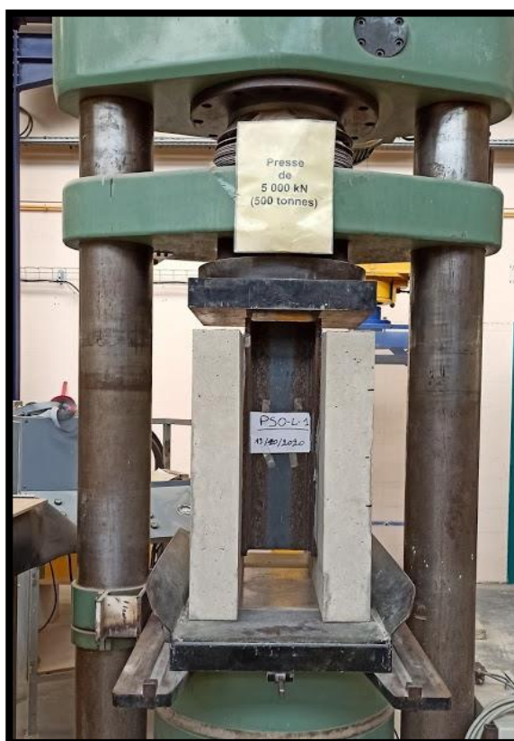
Figure 3.14 Installation du spécimen de push-out dans la presse hydraulique.
