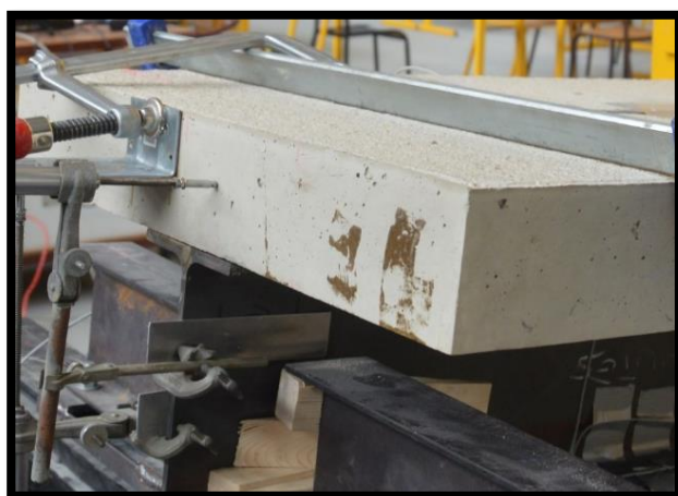
(a) Cas de la connexion complète ‘PM-CC’.
