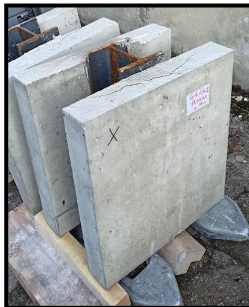
(b) Etat des dalles de béton des spécimens avec les l'OCAL-(4x60)-S460.
