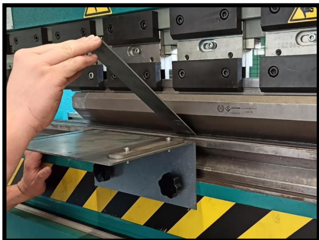
(c) Pliages pour former les deux montants latéraux du connecteur OMEGA.
