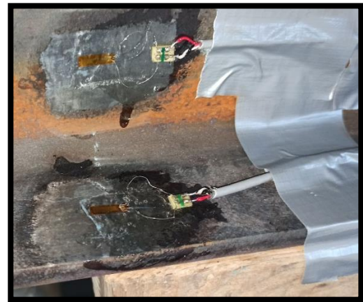
(b) Jauges connectées à des câbles électriques
