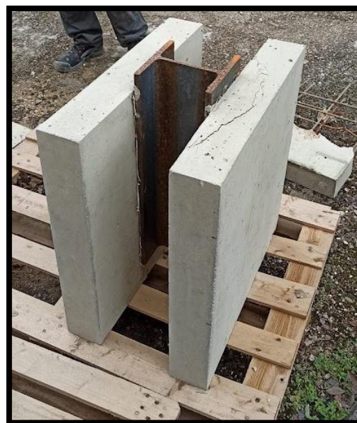
(b) Etat des dalles de béton des spécimens avec les l'OCAL-(4x60)-S355.
