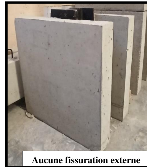
(b) Etat des dalles de béton des spécimens avec les OCPT-(3x50).
