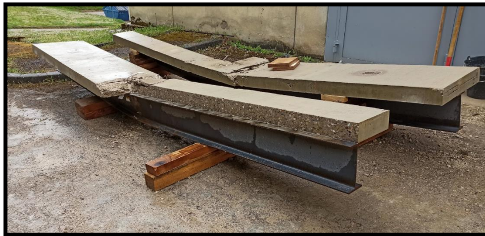
(b) Coupes longitudinales sur le long des longueurs de cisaillement des spécimens.
