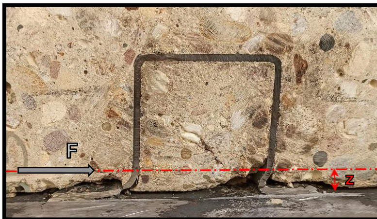
(a) Coupe sur la dalle de béton du spécimen avec les OCPL-(3x50).
