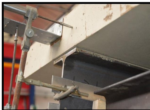
(b) Cas de la connexion partielle ‘PM-CP’.
