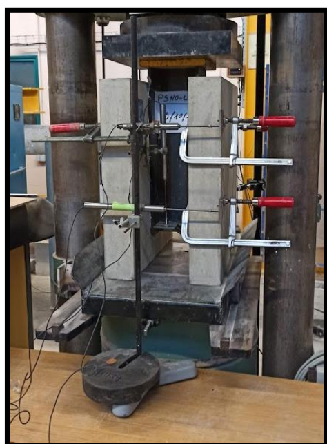
(b) Installation des LVDT
