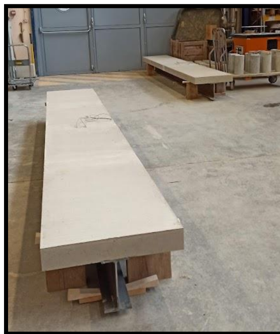
(g) Spécimens de poutre mixte prêt à être tester
