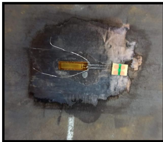
(b) Jauge collé sur la surface traitée.
