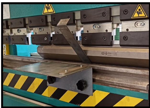
(d) Pliages pour former les deux semelles du connecteur OMEGA.
