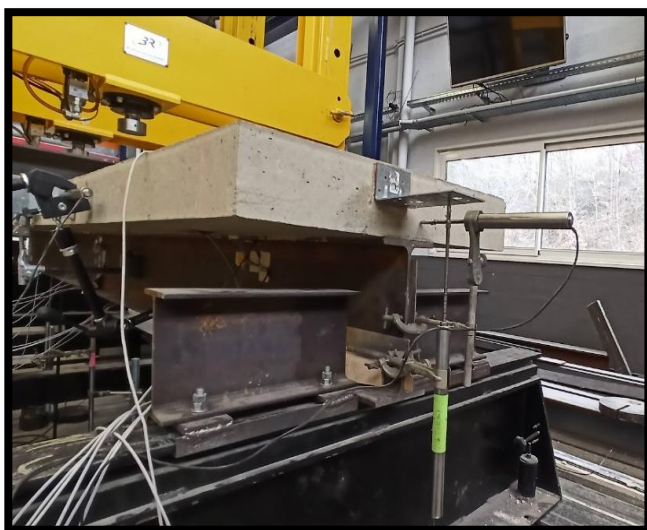
(b) Capteurs LVDT sur l'extrémité.
