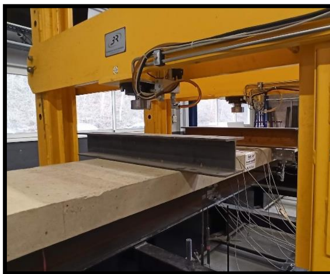
(b) L'ajout du profilé HEB180 sous les vérins hydrauliques.
