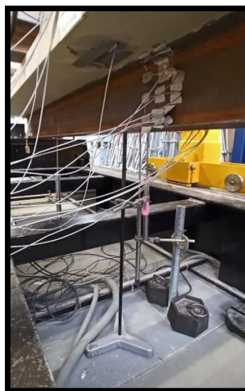
(c) Capteurs LVDT à mi-travée.
