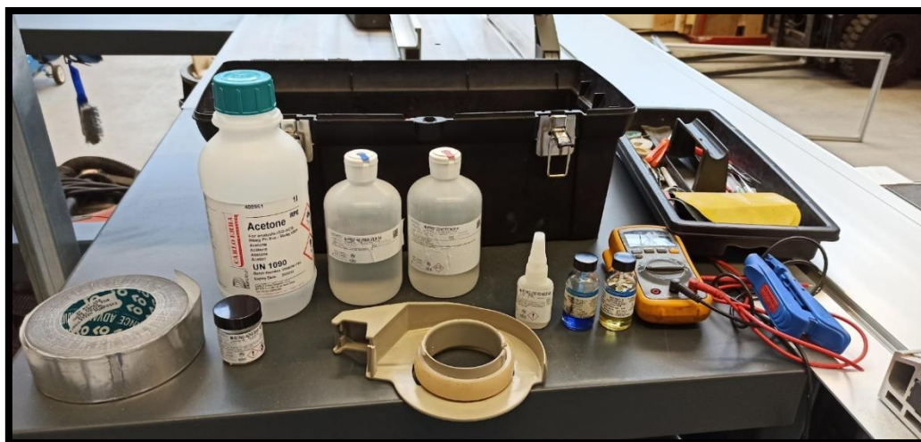
(a) Les produits et accessoires pour le traitement des surfaces des jauges.
