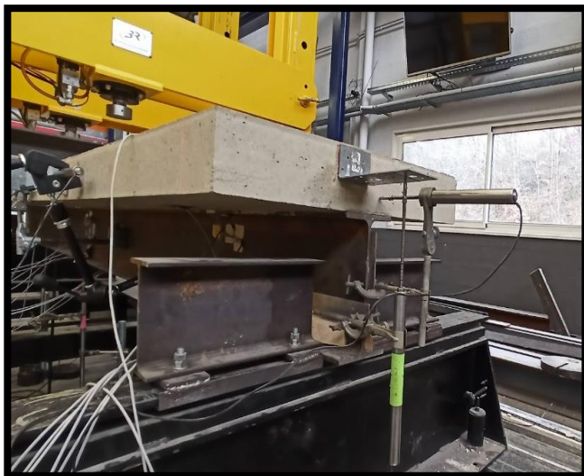
(b) Capteurs LVDT sur l'extrémité.
