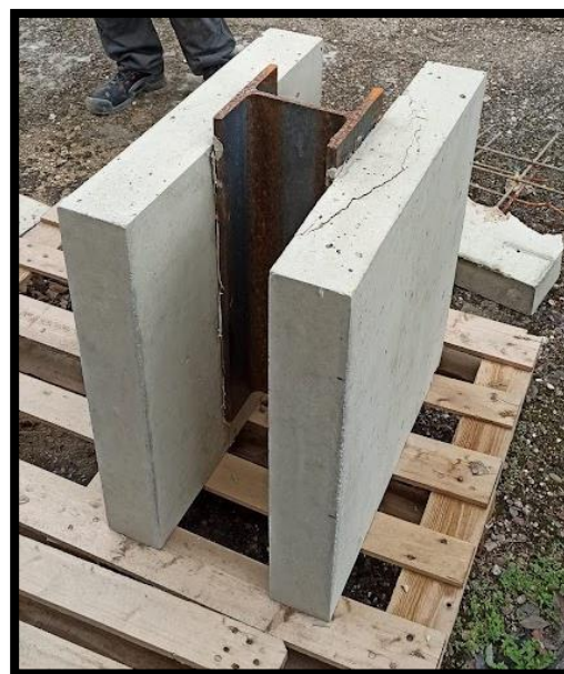
(b) Etat des dalles de béton des spécimens avec les l'OCAL-(4x60)-S355.
