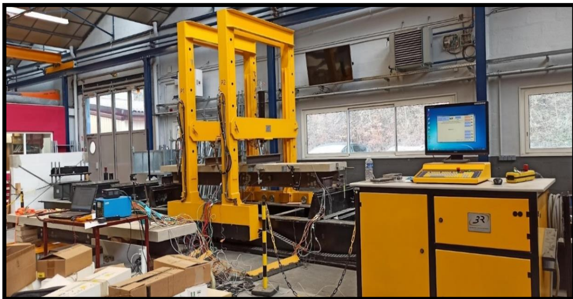
(e) Vue général de l'essai de poutre mixte.
