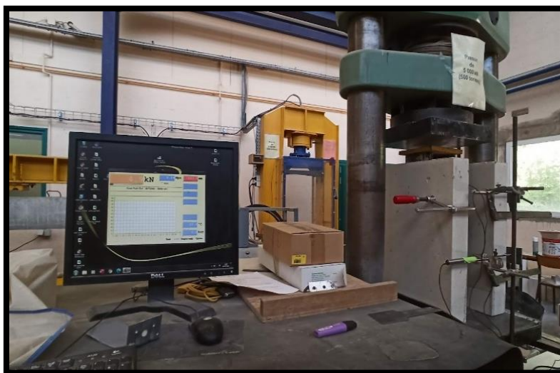
(a) Mesure des déplacement LVDT
