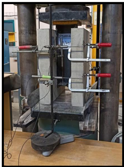
(b) Installation des LVDT
