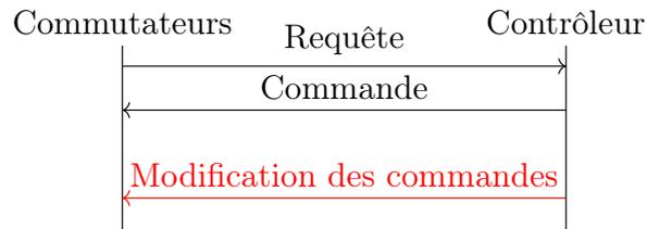
FIGURE 1.13 – Diagramme de séquence du cas d’une attaque Flow Rule Modification. On se place après le régime permanent et l’installation des chemins et autres règles.
