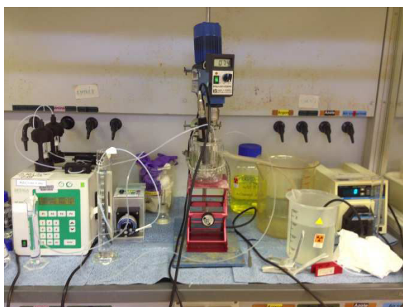
Figure 4.2 – Montage expérimental en régime continu pour l'étude de la cinétique d'agglomération
