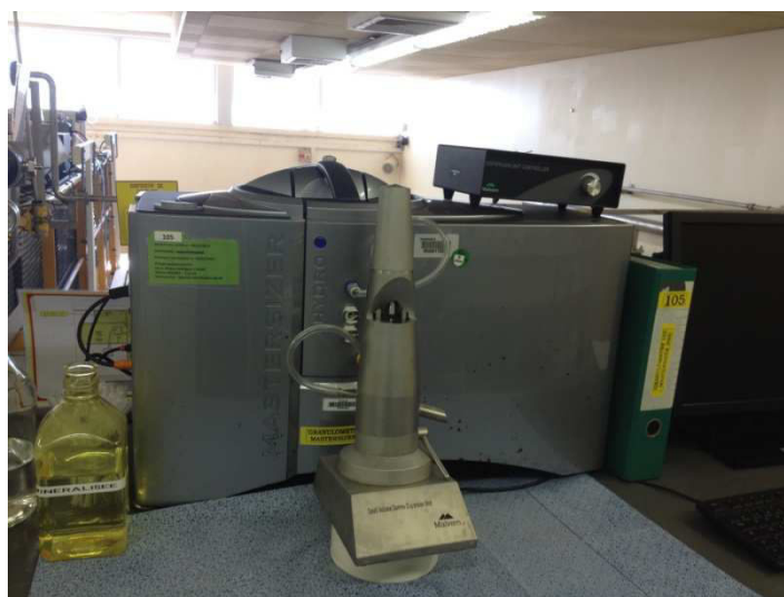
Figure A3.1 - Granulomètre laser utilisé lors de l'étude des mécanismes d'agglomération
