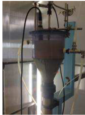
Figure 5.2 – Sonde de pH installée dans la Zone 2 (pour les Expériences 1, 2 et 3)
