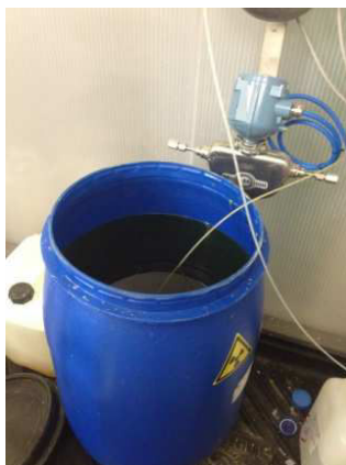
Figure 5.4 – Solution d'alimentation de sulfate d'uranyle
