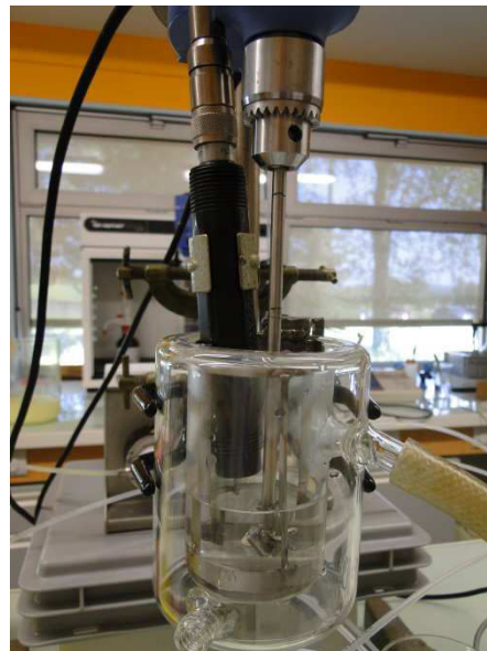
Figure 4.1 – Schéma et photo du précipitateur standard à surverse
