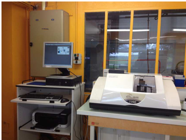
Figure 5.9 – Granulomètre CILAS 1190 utilisé dans l'étude expérimentale en lit fluidisé
