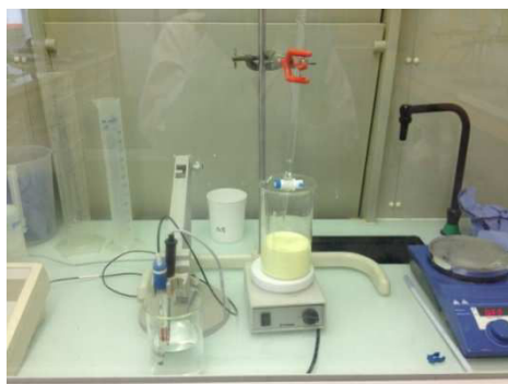
Figure 5.6 – Test de précipitation d' \text{UO}_2(\text{O}_2) \cdot 4\text{H}_2\text{O} à l'échelle de laboratoire
