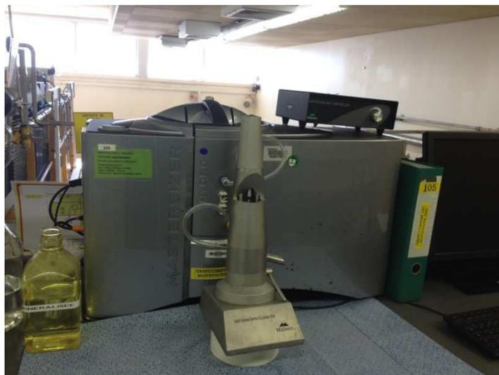
**Figure A3.1** - Granulomètre laser utilisé lors de l'étude des mécanismes d'agglomération
