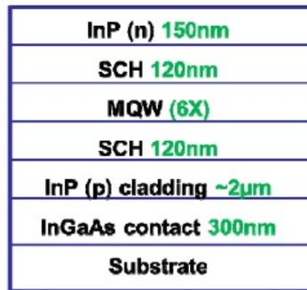
FIGURE 5.4 – Structure de la diode laser dans le composant complexe
