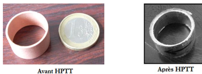
Figure 10 : Echantillon HPTT avant et après déformation
