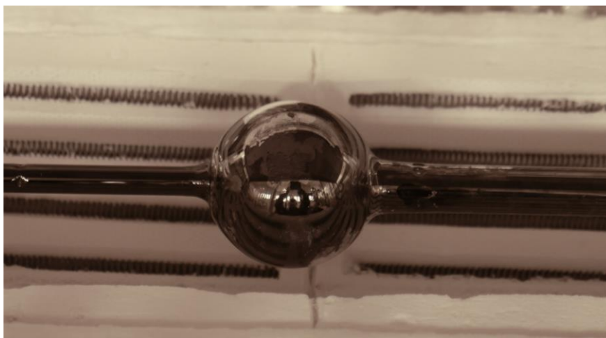
Figure 71 : Photo du réacteur sphérique après pyrolyse d'acétylène pur, lavage à l'azote et refroidissement – présence de HAP et de pyrocarbone 462
