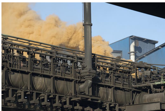
Figure 26 : Nuage de gaz chargé en Benzo(a)Pyrène hautement cancérigène lors d'une fuite d'un four en pleine pyrolyse du charbon – Cokerie de Dunkerque, 2014
