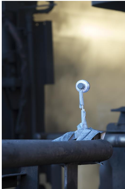
Figure 27 : Capteur passif de HAP muni d'un filtre à particule et d'une résine XAD2 pour la phase gazeuse - Cokerie de Dunkerque
