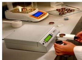
Mesure de la succion avec le Potentiomètre Decagon WP4C®
