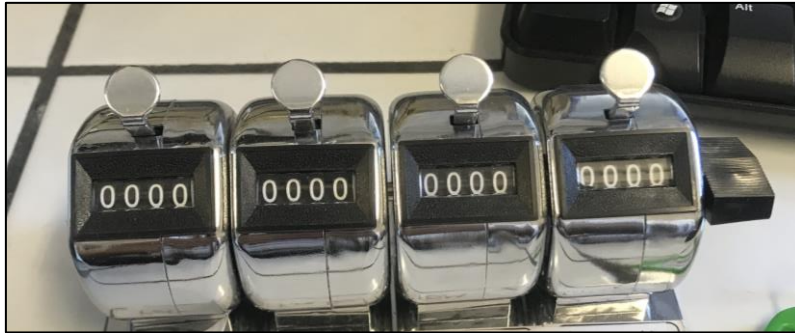
Figure 35 : Compteurs utilisés pour compter le nombre de particules organiques d'origine naturelle, organiques d'origine anthropique, minérales d'origine naturelle, minérales d'origines anthropiques pour les fractions de sols
