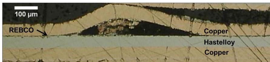
Figure I-17 Image microscopique d'un délaminage dans un ruban SHT-2G [Maj13].
