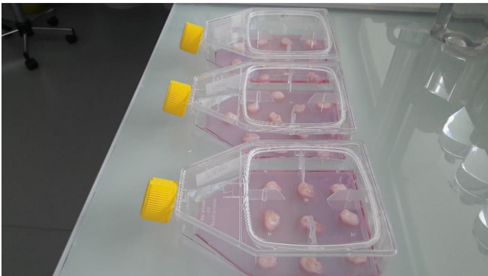
Figure 12. Technique des explants. Les cordons ombilicaux sont sectionnés en tranches et placés dans des flasques avec du milieu \alpha MEM + LP 5%, puis incubés en hypoxie à 37°C.
