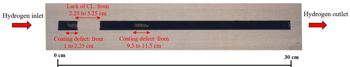
Figure 5.1 : Anode avant transfert sur la membrane avec un manque de couche active et défauts d'enductions. Le défaut de manque de couche active est situé à l'entrée de l'hydrogène.
