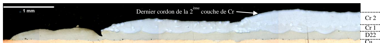
Figure 78 : cliché optique d'une coupe (normale au sens de balayage) du dépôt de 2 couches de Cr sur D22-Cu
