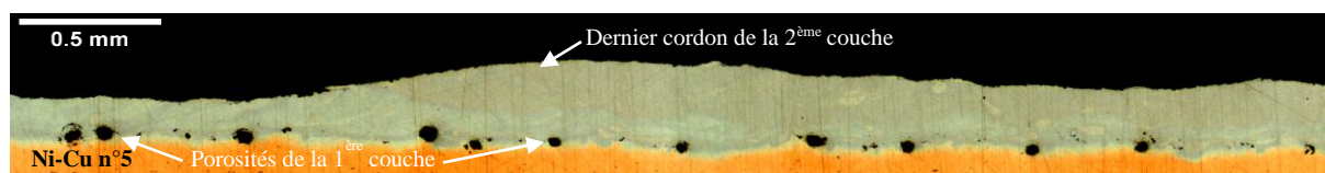
Figure 72 : cliché optique d'une coupe (normale au sens de balayage) d'un dépôt de 2 couches de Ni sur Cu
