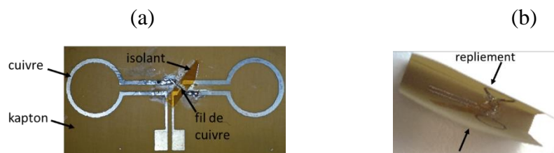
Figure 2.3 : réalisation de la milli-bobine Helmholtz. (a) géométrie 2D et (b) géométrie 3D.
