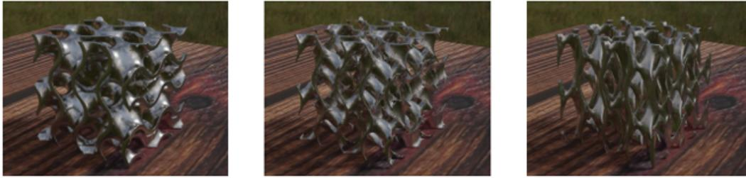
**FIG. 7.5** – Formes des canaux : Optimisation de la matrice poreuse TPMS pour des différentes itérations (Krischok and Keip (2021))
