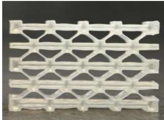
Figure I-4 : Matériaux architecturés pour piéger les contraintes élastiques (S. Shan et al., 2015).
