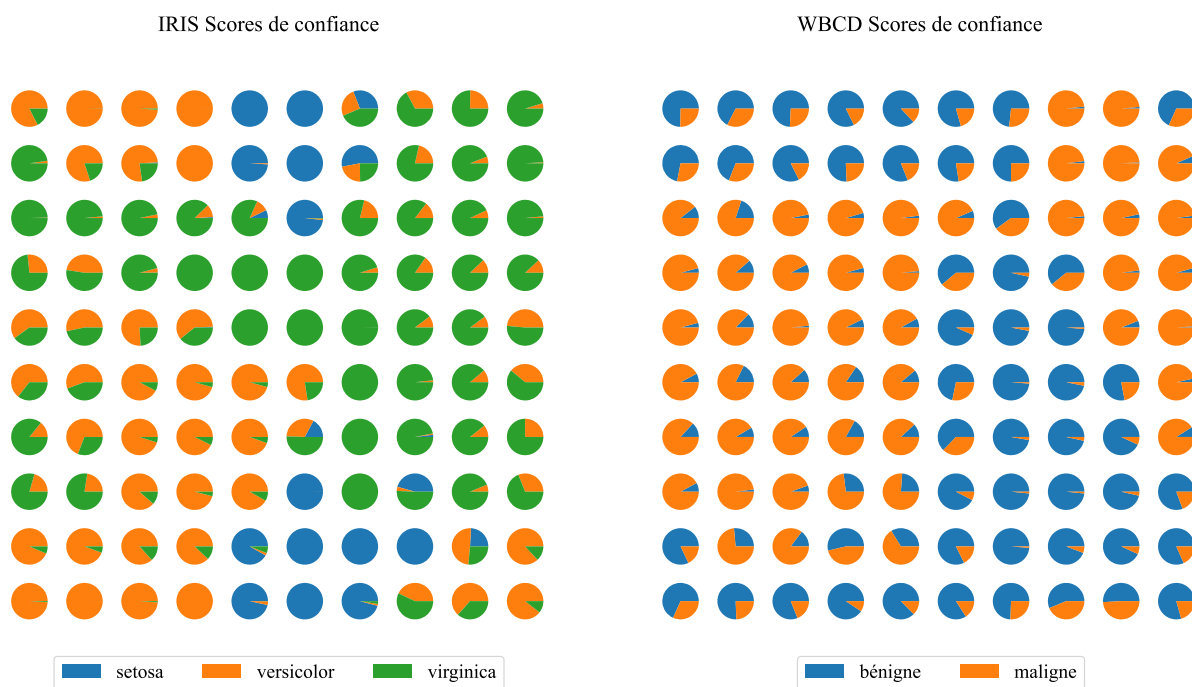
FIGURE 6.16 – Exemples de scores de confiances obtenus après la phase d’étiquetage, pour une carte de 10 \times 10 neurones, une modulation spatio-temporelle et le schème de vote TMP-POP. Il s’agit ici d’une visualisation des scores de confiances \text{conf}(i, h) générés par TMP-POP, avec i indiquant un neurone et h indiquant une valeur de catégorie. Ces scores de confiances ont été accumulés et normalisés pour les différentes catégories, i.e. la somme des \text{conf}(i, h) donne 1.
