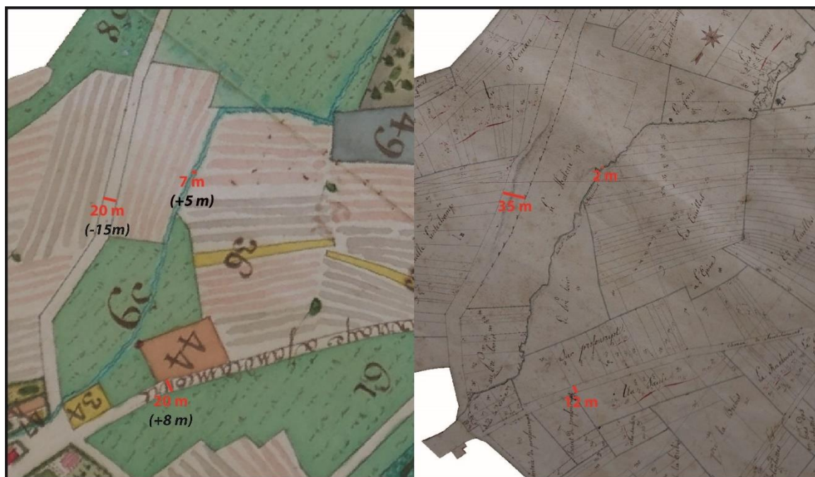
20 m Largeur (en mètres) mesurée sous QGIS (+8 m) Différence entre la largeur mesurée sur le plan cadastral et celle mesurée sur le plan-terrier
