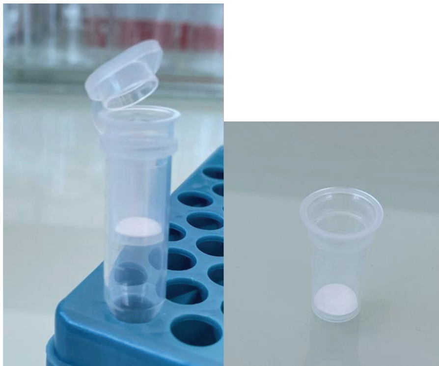
FIGURE 29: MEMBRANE EN CELLULOSE REGENEREES DANS LE DISPOSITIF CENTRIFUGEABLE.
