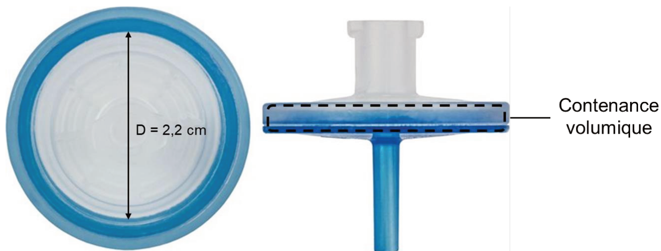
FIGURE 9: MEMBRANE EN CELLULOSE REGENEREES UTILISEE POUR LA NANOSTRUCTURATION.
