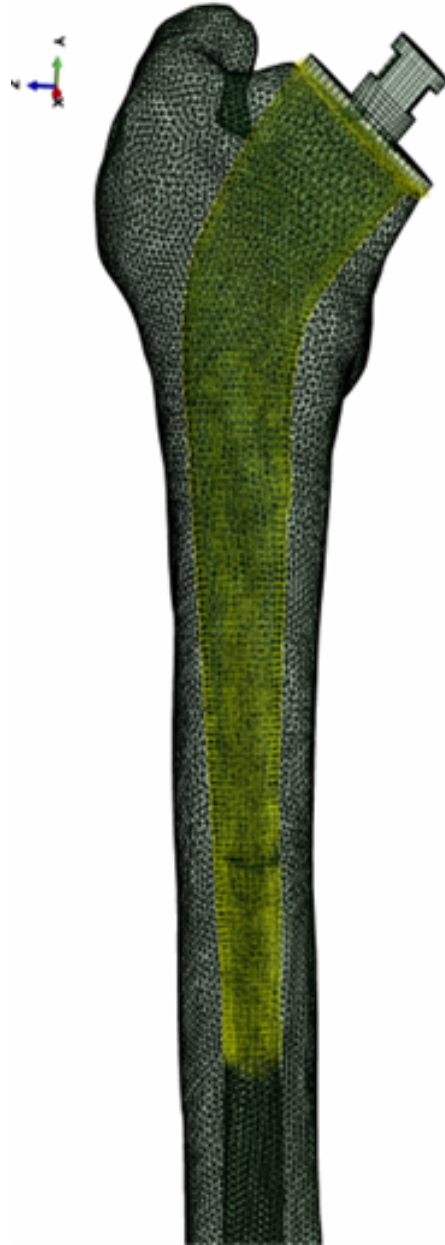
FIGURE 3.9 – Contact entre la prothèse et le fémur
