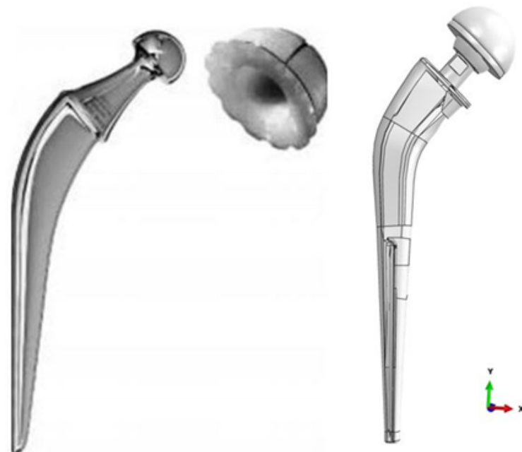
FIGURE 2.10 – Prothèse de Charnley et géométrie récupérée du logiciel GrabCad®
