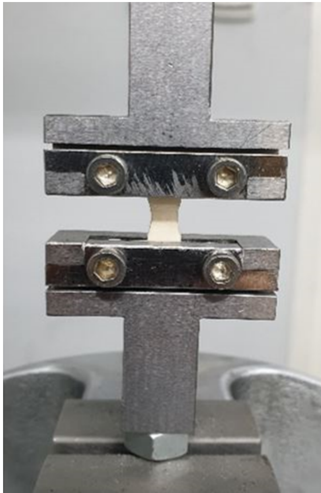
FIGURE 5.14 – Les mors de fixation des éprouvettes
