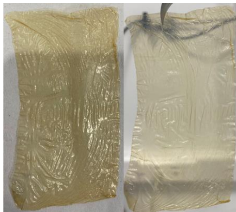
Figure V.5 : Aspect d'une membrane hybride sPEEK HTU 7,6 %.
