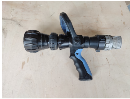
(a) Exemple de lance à main utilisée en France
