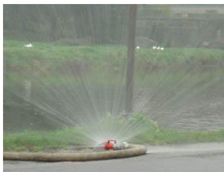
FIGURE 1.3 – Jet de protection obtenu avec une lance de type queue de paon
