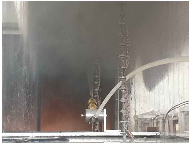
FIGURE 4.3 – Essai réalisé avec un spray ascendant incliné à 45°
