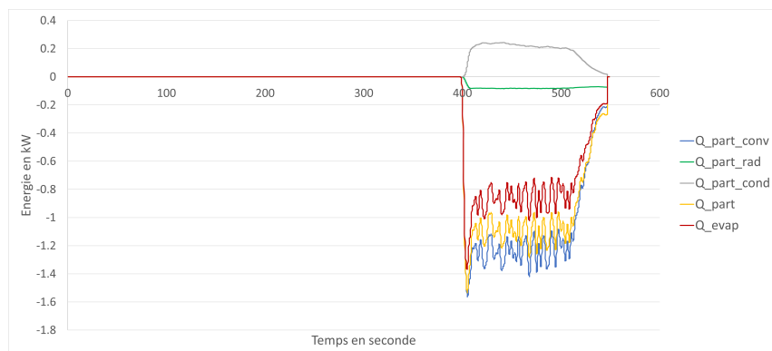
FIGURE 5.10 – Répartition des échanges thermiques sur les particules mesurés par FDS.
