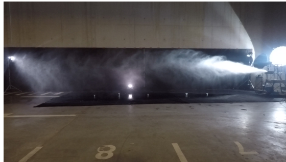
(a) Brouillard produit avec la buse plate
