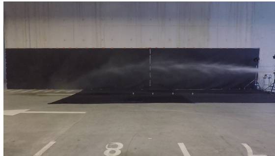
(b) Brouillard produit avec la buse ronde
