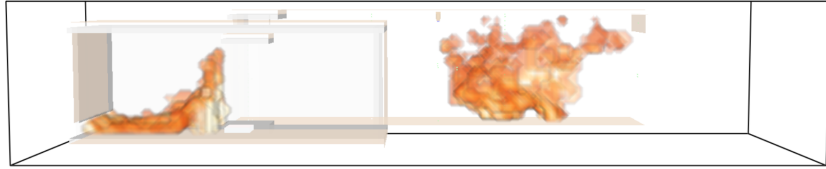
FIGURE 5.16 – Ré inflammation observable dans la simulation après injection à cause de la sous-ventilation.
