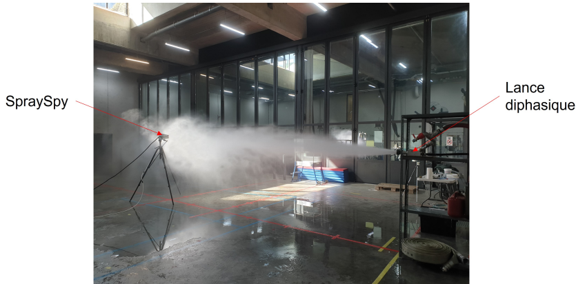
FIGURE 2.6 – Photographie du banc d'essai pour les mesures de granulométrie et de vitesse des gouttes
