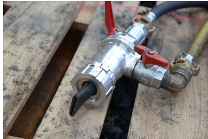
(a) Premier prototype de la lance diphasique, octobre 2019
