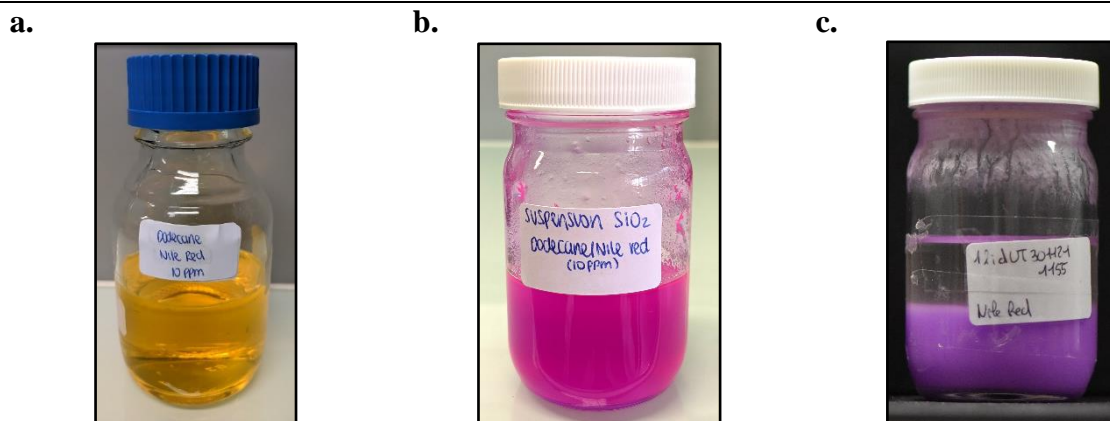
Figure 5. Photographies (a) d'une solution huileuse de rouge de Nile à 10 ppm, (b) de sa suspension correspondante avec 1 wt.% de particules de silice à 10 ppm de rouge de Nile et (c) d'une émulsion avec 1 wt.% de particules et 20 % de dodécane à 10 ppm de rouge de Nile.
