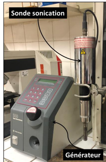
Figure 1. Photographies illustratives des (a) rotor-stator et (b) sonicateur utilisés dans les procédés d'émulsification.
