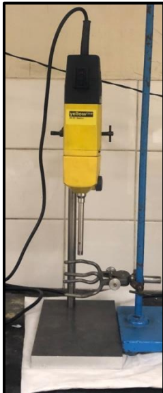
Figure 1. Photographies illustratives des (a) rotor-stator et (b) sonicateur utilisés dans les procédés d'émulsification.
